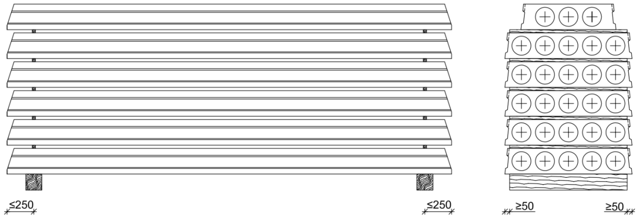
rys. 3 Sposób składowania prefabrykatów
